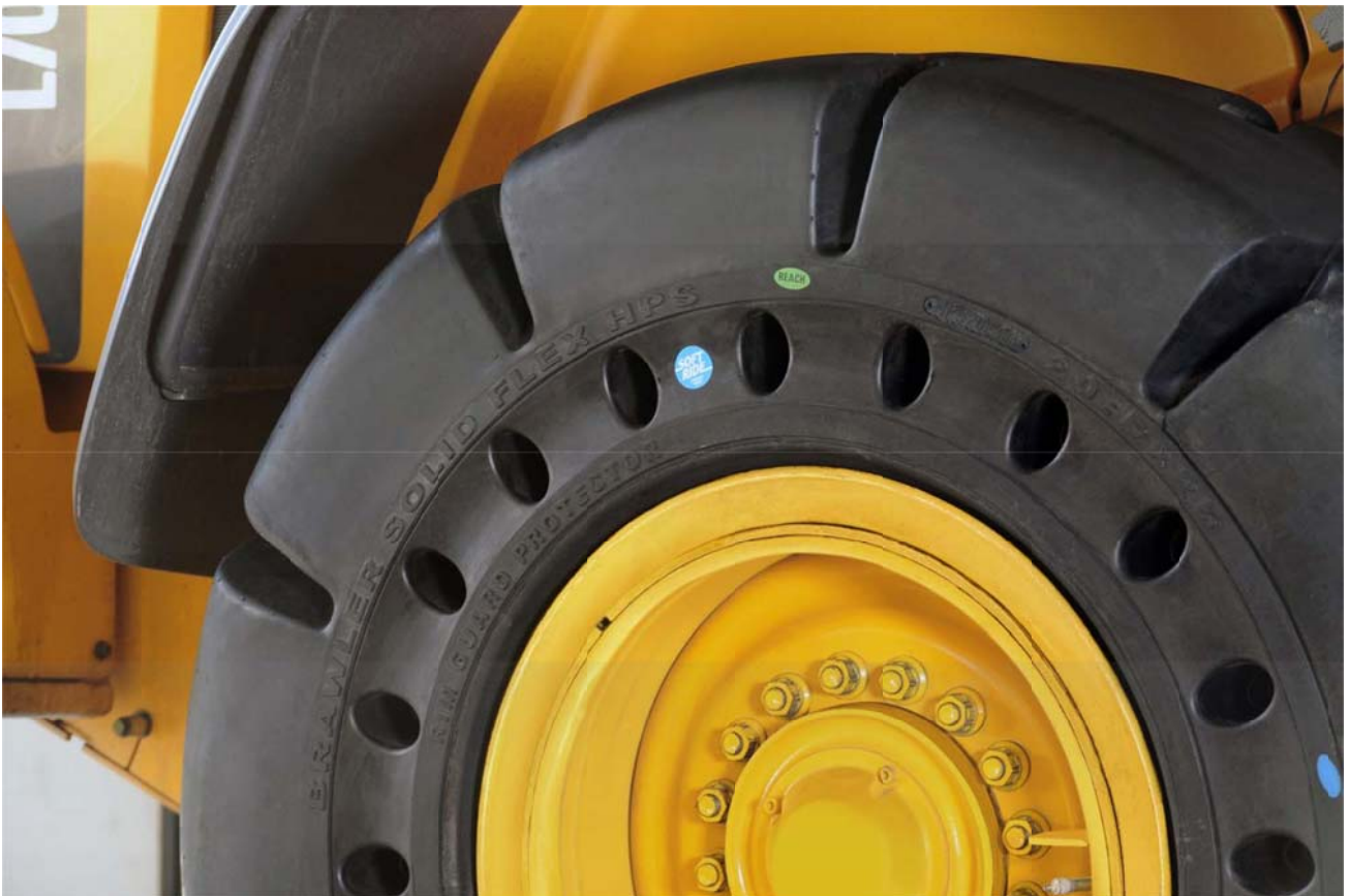
Brawler HPS Soft Ride 轮胎是一种新型的实心轮胎，专门设计用于废物管理和回收行业。（图片：特瑞堡车轮系统公司，TWSPR011）
